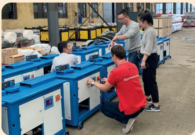
Контроль производства скоростных гибщиков арматуры
